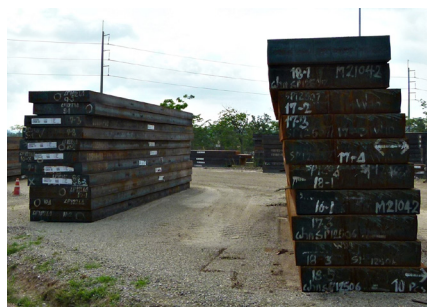
แท่งเหล็กก่อนผ่านกระบวนการรีดร้อน
